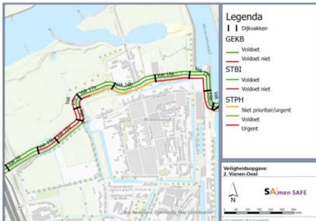
Figuur 6.2: Veiligheidsopgave planuitwerkingsfase dijkzone 2. De rode lijn geeft aan welke delen niet voldoen aan de norm
