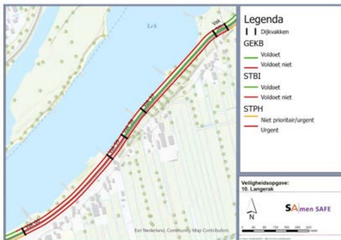
Figuur 13.2: Veiligheidsopgave planuitwerkingsfase dijkzone 10. De rode lijn geeft aan welke delen niet voldoen aan de norm
