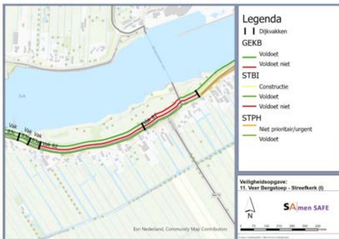
Figuur 14.3: Veiligheidsopgave planuitwerkingsfase dijkzone 11-I. De rode lijn geeft aan welke delen niet voldoen aan de norm
